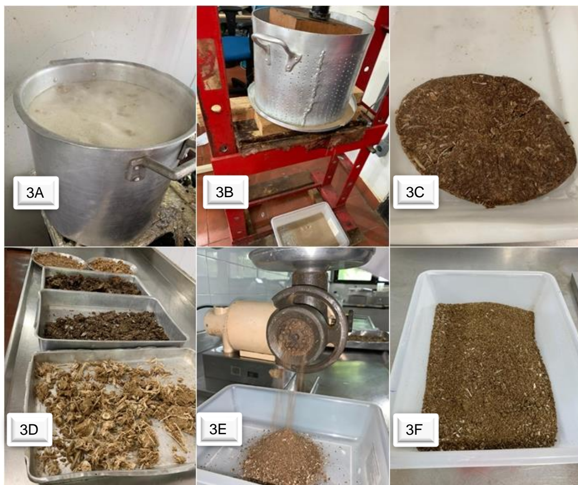
Figura 3. Etapas da produção de farinha de resíduos de peixe. 3A. Cocção; 3B. Prensagem; 3C. Torta de prensa; 3D. Desidratação; 3E. Segunda trituração; 3F. Produto final. Fonte: Autor (2020).
