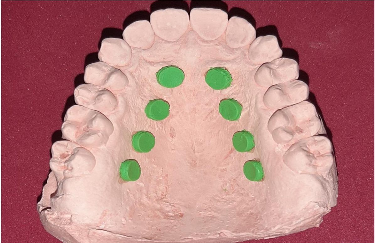
Figura 5 – Amostras de silicone de condensação fixadas no modelo
