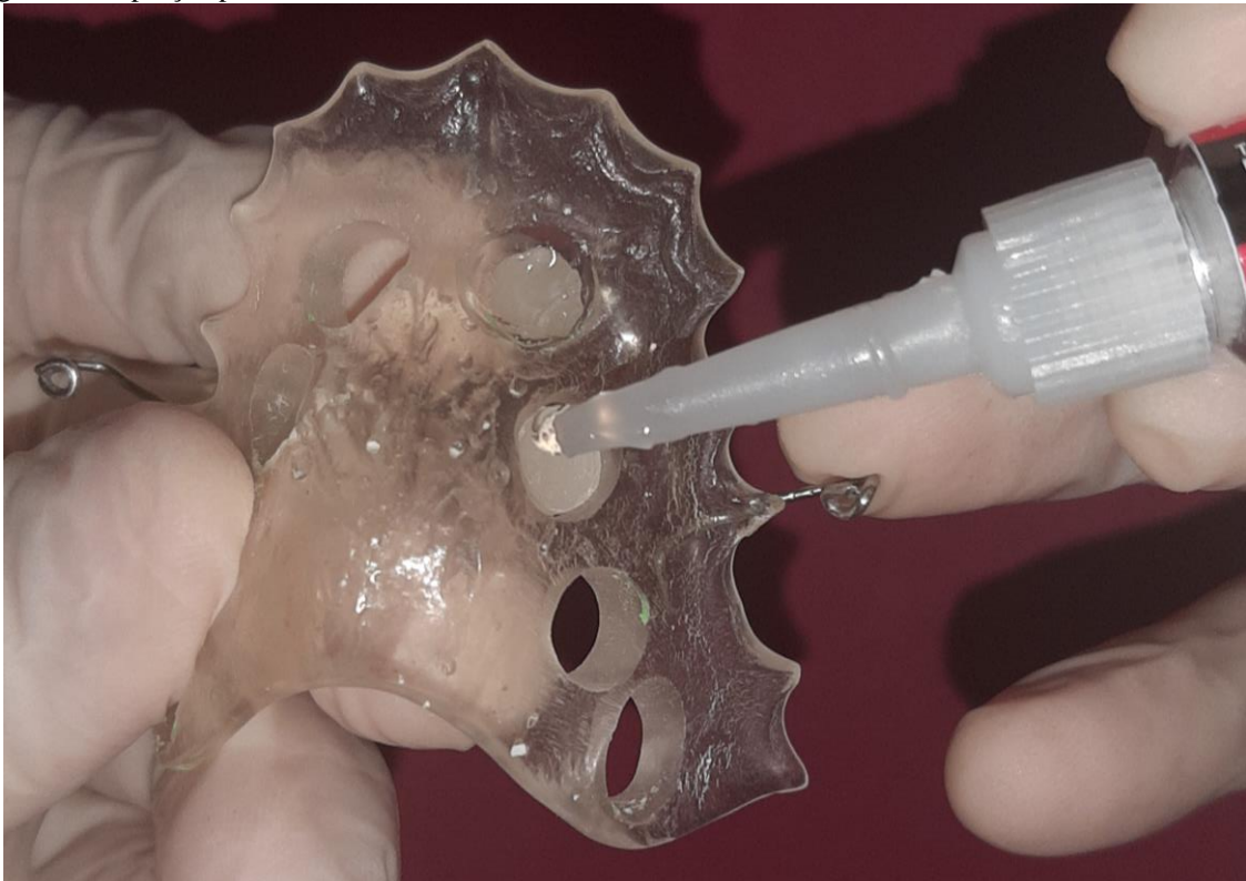
Figura 8 – Aspecto do dispositivo com as amostras em posição, a serem fixadas com cola de cianoacrilato gel em sua porção posterior
