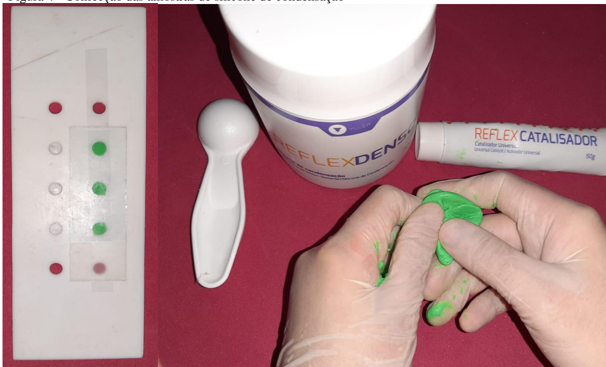
Figura 4 - Confeção das amostras de silicone de condensação
