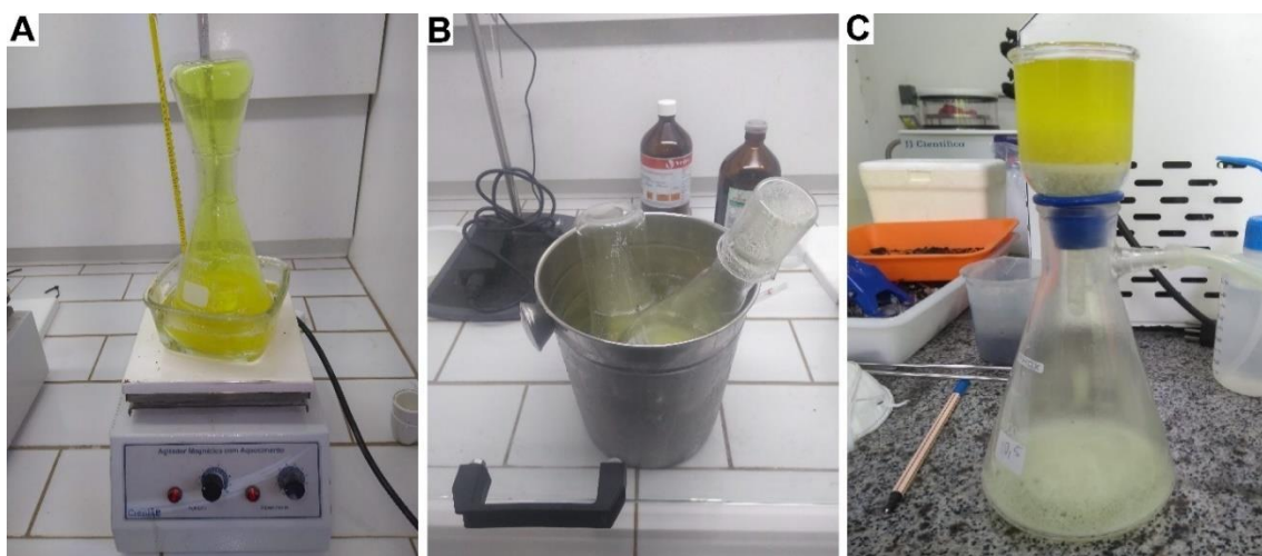
Figura 16: A) Banho maria de glicerina; B) Banho gelado C) Filtração da holocelulose. Fonte: Autor
