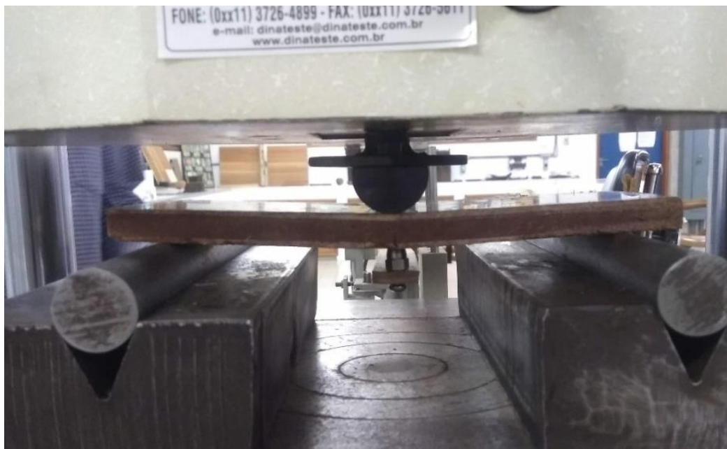
Figura 37: Ensaio de flexão da placa com adição de 10% de fibra. Fonte: Autor.
