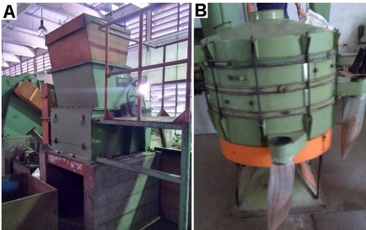
Figura 10: A) Moinho para extração das fibras; B) Máquina Allgaier Sifter. Fonte: Autor
