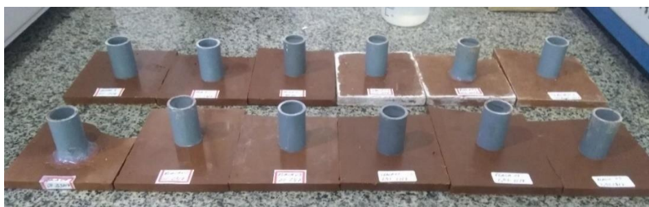
Figura 31: Ensaio de permeabilidade. Fonte: Autor.
