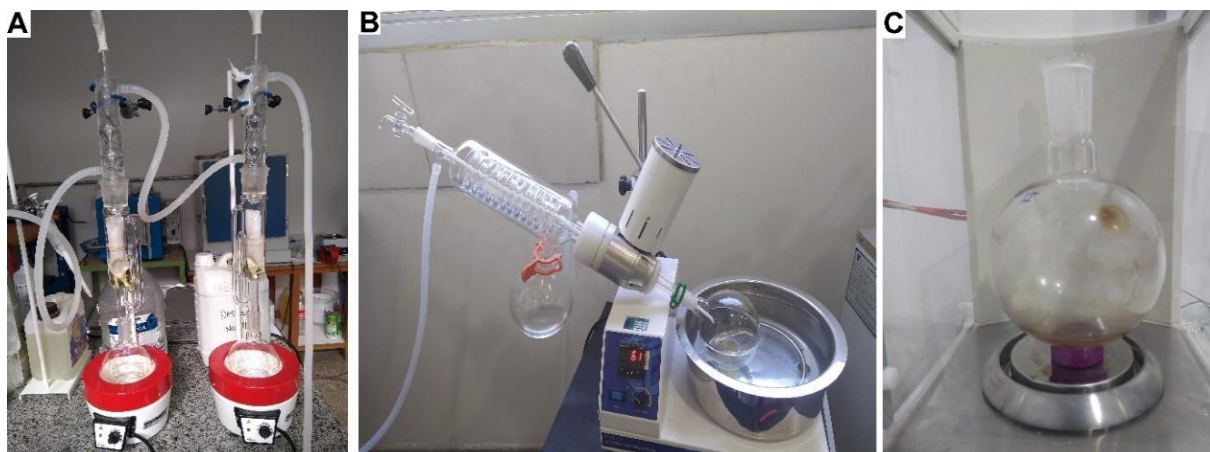
Figura 14: A) Esquema de extração; B) Evaporador Rotativo; C) Balão com extrativos. Fonte: Autor
