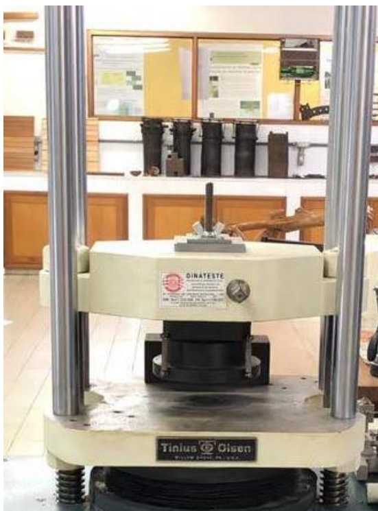
Figura 26: Máquina de ensaios universais de força. Fonte: Autor.
