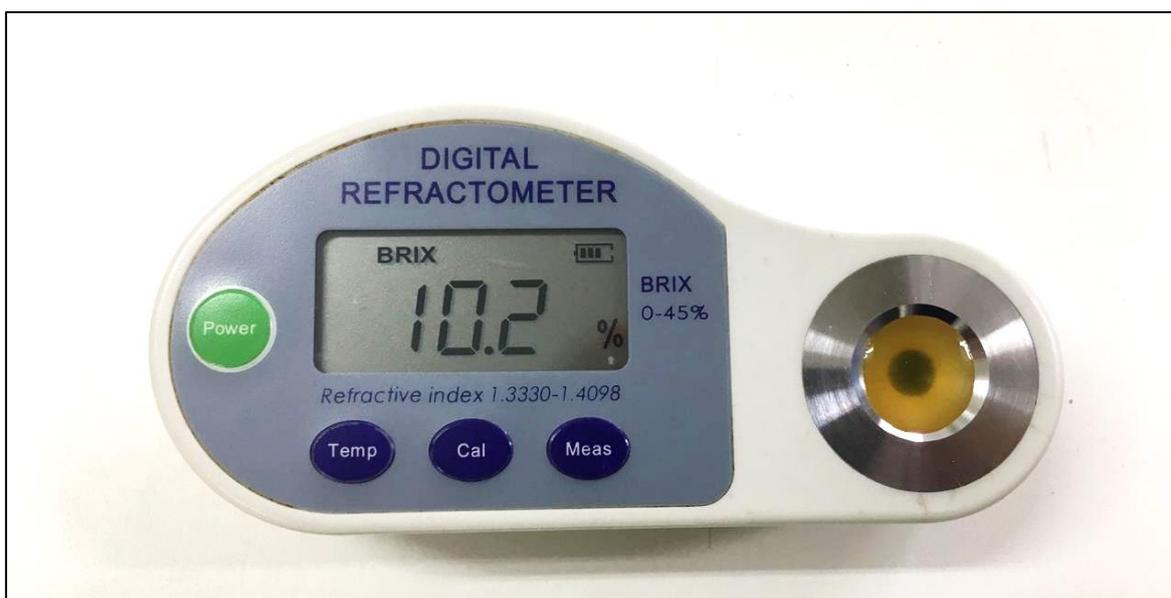
**Figura 15.** Medição do °Brix do suco de laranja 'Pêra' com refratômetro.
