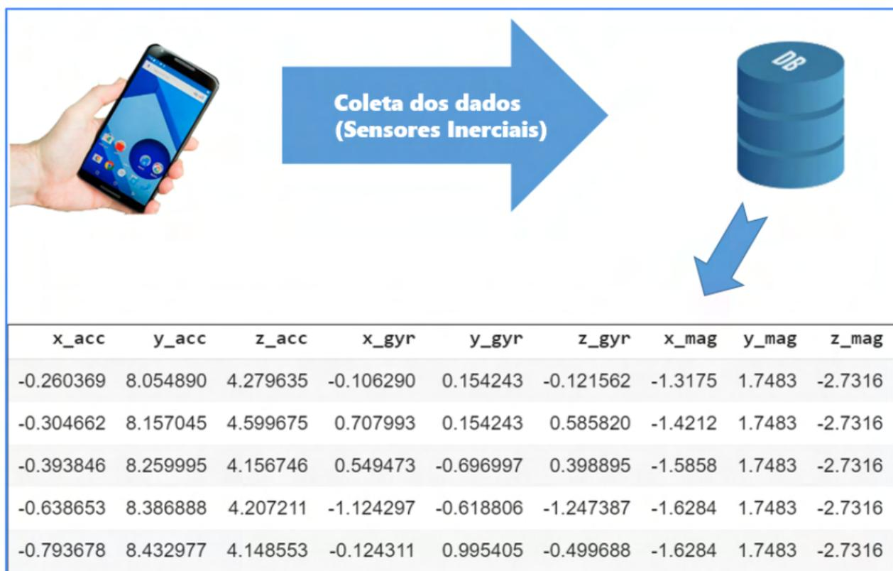
Figura 4.2 – Dados brutos de Sensores Inerciais. Fonte: Autor
