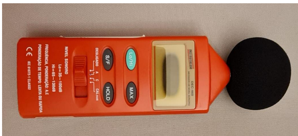
Figura 7. Decibelímetro usado para medir o nível de ruído.
