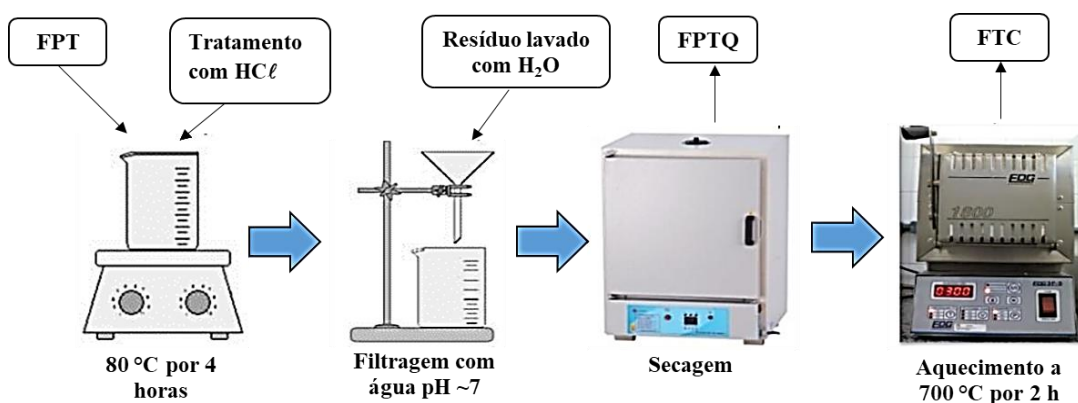
Figura 15. Procedimento para obtenção da metacaulinita a partir da fração fina de caulinita, adaptado de Freitas (2013).
