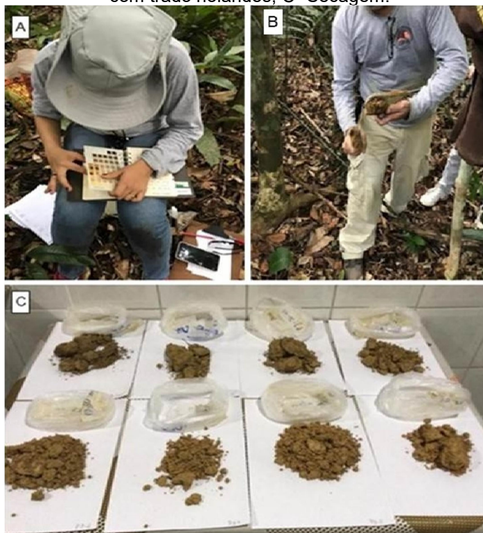
Figura 9. A - Identificação das cores do solo (tabela Munsell Soil Color Charts ); B- coleta da amostra com trado holandês; C- Secagem.
