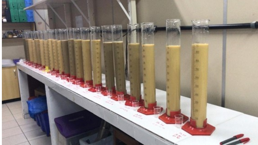
Figura 9. Processo de decantação da argila pelo método da EMBRAPA (1997).
