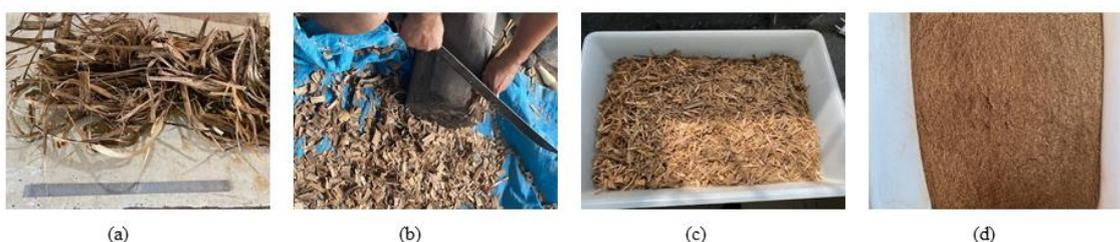
**Figura 31.** (a) Seleção da fibra, (b) Redução da fibra em corte artesã, (c) Fibra reduzida no processo liquidificador, (d) Fibra processada no moinho de facas (Autor, 2021).
