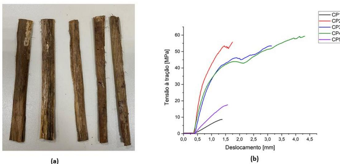
**Figura 45.** (a) Corpo de prova da fibra *in Natura*; (b) Tensão à Tração x Deformação da fibra *in Natura*
