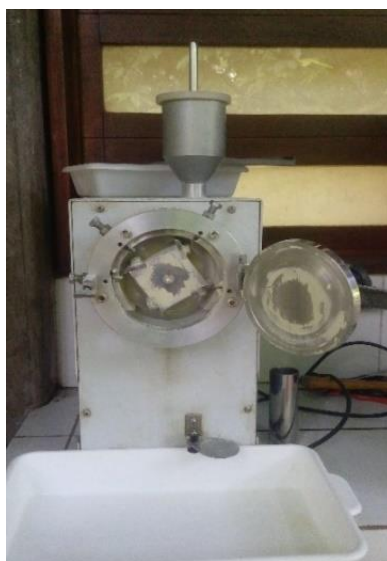
Figura 9. Moinho de facas utilizado para processar as raízes de P. sprucei Próprio Autor.
