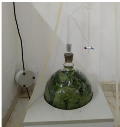
Figura 3. Hidrodestilação em aparelho de Clevenger.
