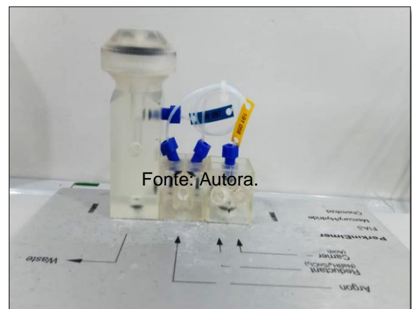
Figura 4: Esquema de funcionamento bloco de misturas Chimefol - PerkinElmer (gerador de hidretos), adaptado.
