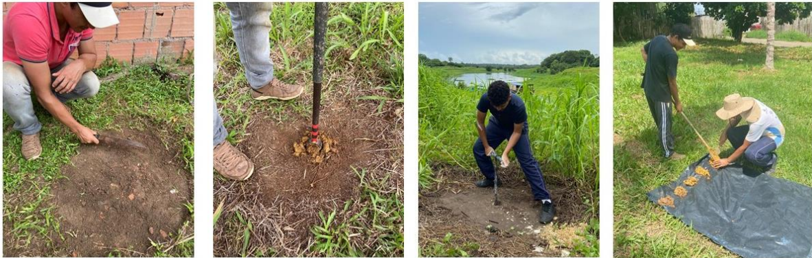
Figura 4 – Limpeza da área de trabalho, aprofundamento do trado nos centímetros iniciais, coleta do material e disposição das amostras em uma lona para seleção visual, respectivamente.
