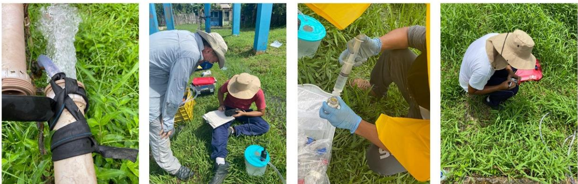
Figura 3 – Etapas de coleta da água: ajuste da mangueira com tiras de borracha, leitura dos parâmetros de estabilização da água, inserção da água no frasco e identificação do frasco contendo a amostra, respectivamente.
