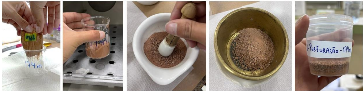
Figura 7 – Disposição do solo em um becker, secagem em estufa, destorroamento, peneiramento e armazenamento da amostra, respectivamente.
