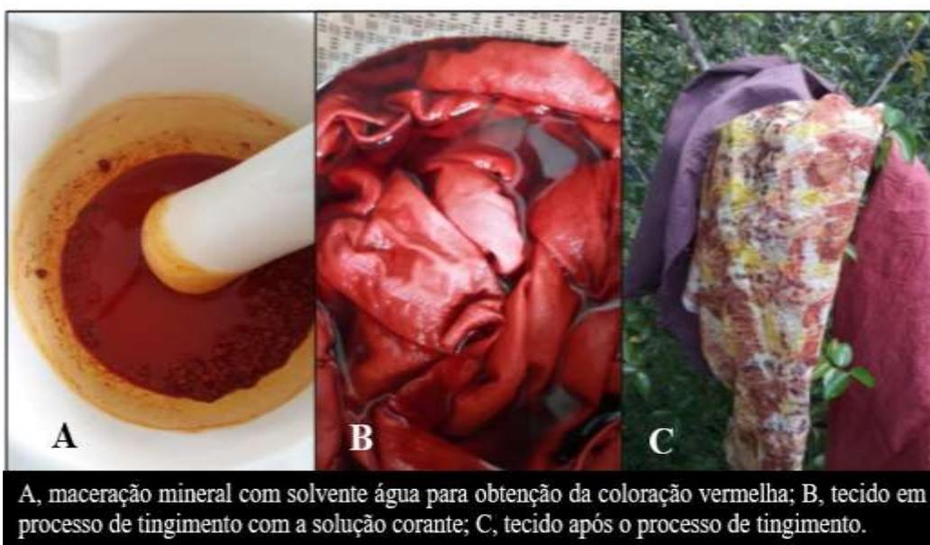
A, maceração mineral com solvente água para obtenção da coloração vermelha; B, tecido em processo de tingimento com a solução corante; C, tecido após o processo de tingimento.
