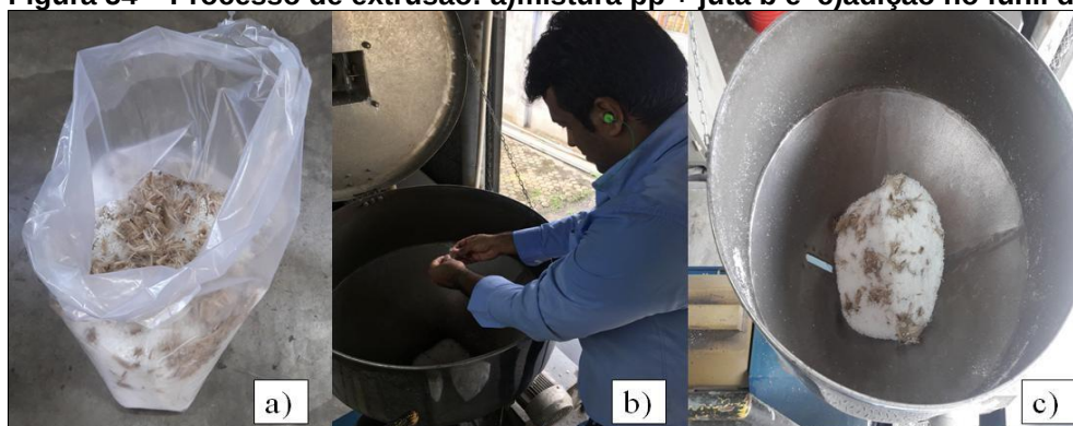
Figura 54 – Processo de extrusão: a) mistura pp + juta b e c) adição no funil de entrada
