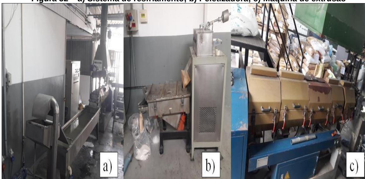
Figura 52 – a) Sistema de resfriamento; b) Peletizadora; c) Máquina de extrusão
