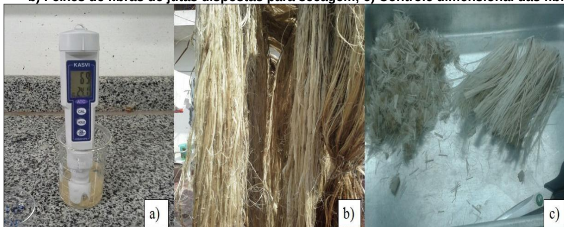
Figura 45 – Mercerização das fibras de juta: a) Obtenção do PH 7; b) Feixes de fibras de jutas dispostas para secagem; c) Controle dimensional das fibras
