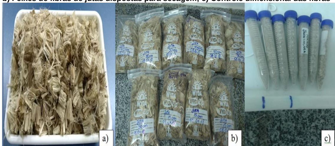
Figura 46 – Mercerização das fibras de juta: a) Obtenção do PH 7; b) Feixes de fibras de jutas dispostas para secagem; c) Controle dimensional das fibras
