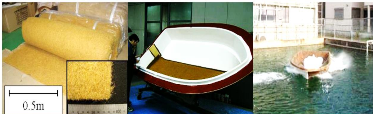
Figura 27 – Barco de pequeno porte desenvolvido com biocompósito de bambu
