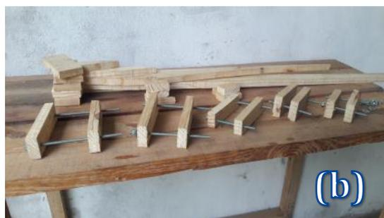
Figura 68. (a) Grampos de madeira, barra roscada, porcas e arruelas. (b) organização para montagem.
