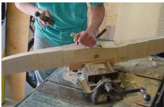
Figura 10. Hélice de madeira sendo entalhada.
