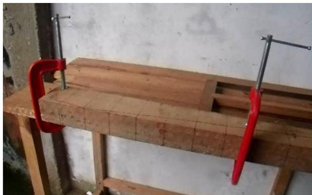
Figura 58. Bloco fixo à mesa para o corte da projeção superior.
