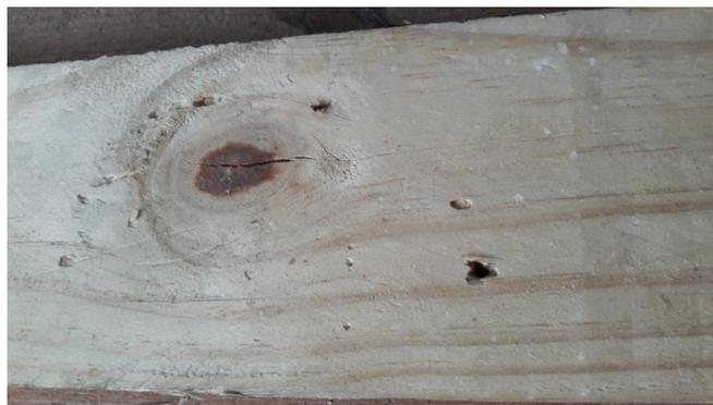
Figura 61. Evitar madeira muito empenada, com furos e rachaduras.
