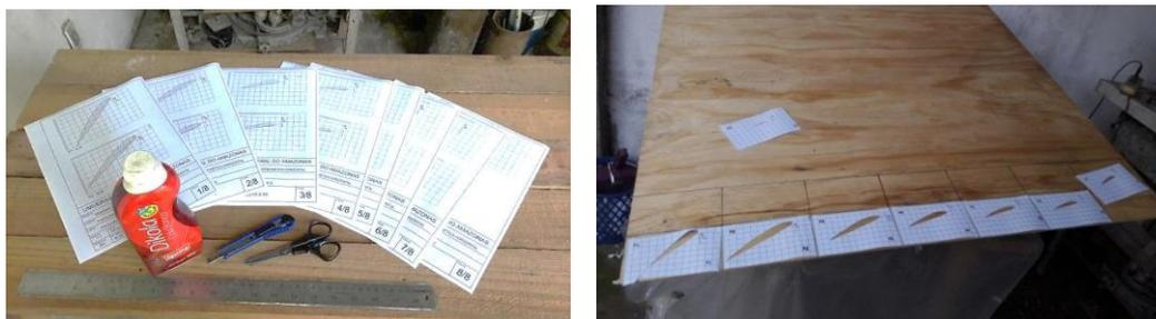
Figura 52. À esquerda o Desenho técnico dos gabaritos das seções transversais, à direita estes são recortados e colados sobre uma folha de compensado. Fonte: O autor (2022).
