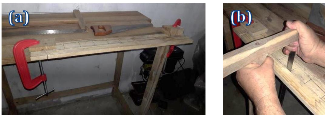
Figura 64. (a) Fixação da lâmina sobre a bancada, (b) corte do contorno. Fonte: O autor (2022).
