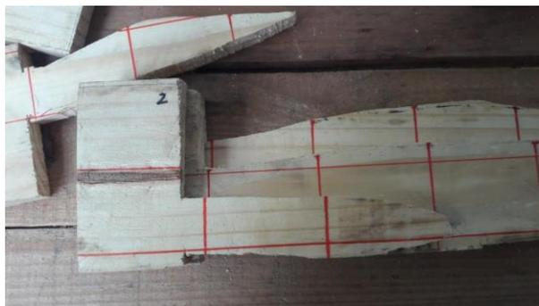
Figura 67. Marcação dos eixos nas lâminas para correto alinhamento.
