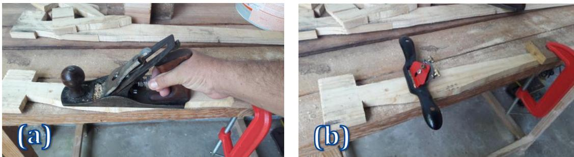
Figura 65. (a) aplainamento realizado com plaina manual, (b) aplainamento com *corteché*.
