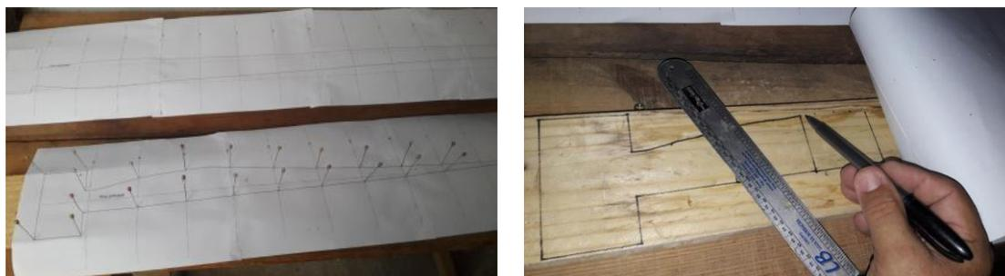
Figura 63. Marcação com alfinetes, para transferência do desenho técnico para a superfície da madeira. Fonte: O autor (2022).
