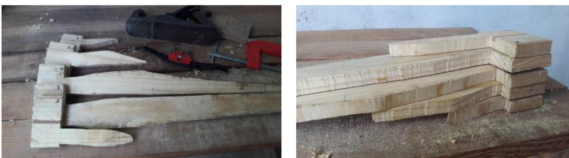
Figura 66. Com as lâminas cortadas, fica claro o plano seriado na longitudinal.
