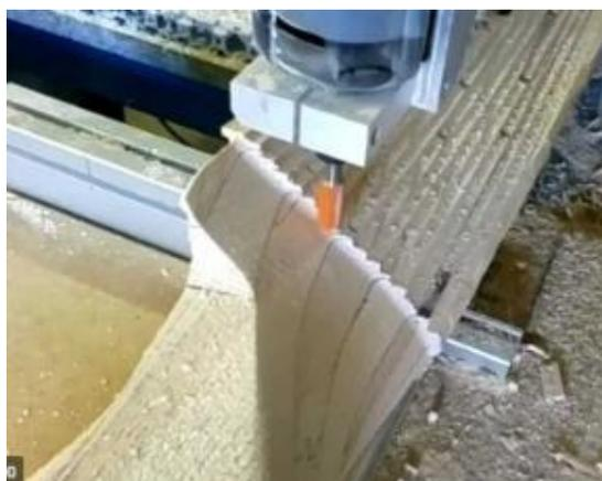
Figura 16. Hélice em madeira sendo usinada automaticamente em uma CNC.
