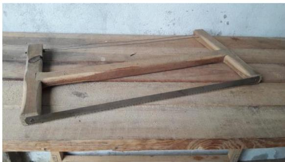
Figura 54. Arco de serra com lâmina horizontal.
