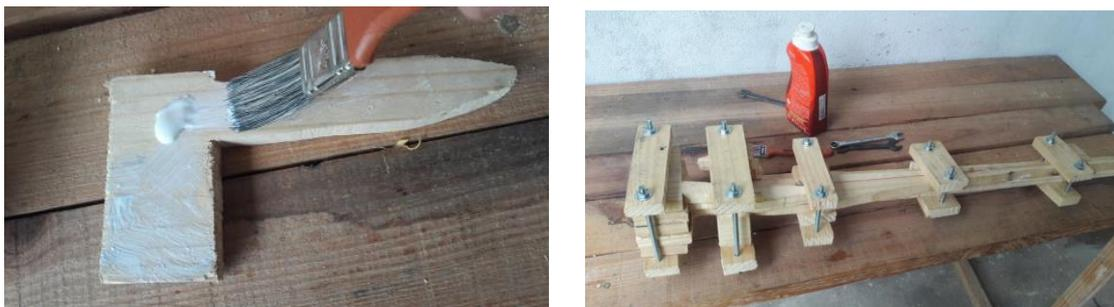
Figura 69. Cola pvc sendo passada em uma das lâminas e conjunto montado e colado.
