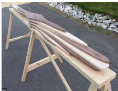
Figura 12. Seções longitudinais empilhadas e coladas.
