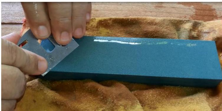
Figura 50. Lâmina do *corteché* sendo afiada sobre a pedra dupla face.
