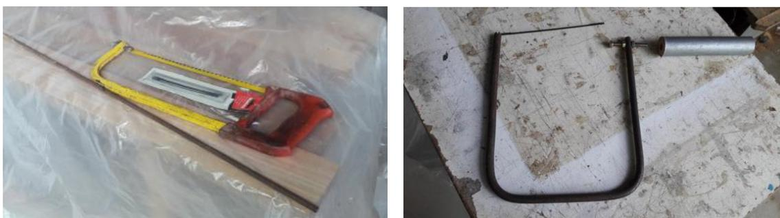
Figura 51. A esquerda o material utilizado, à direita o arco de serra tico tico manual confeccionado pelo próprio usuário.
