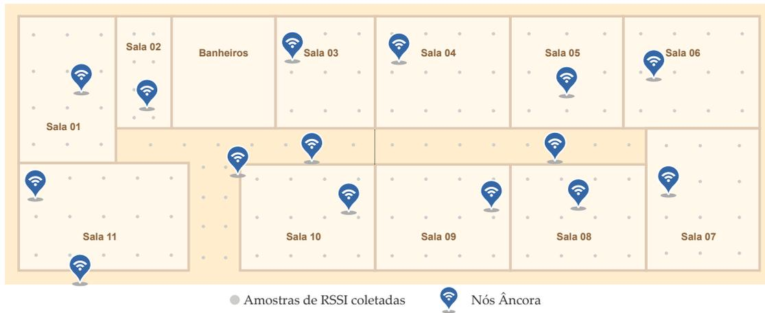
Figura 5.1: Mapa do nosso testbed: 11 salas, 3 corredores, 15 nós âncora e 150 pontos de referência. Para cada ponto de referência, 100 amostras foram coletadas em um total de 15.000 amostras para cada dispositivo móvel. Foram usados 11 dispositivos móveis diferentes, 8 para treinamento e 3 para teste.
