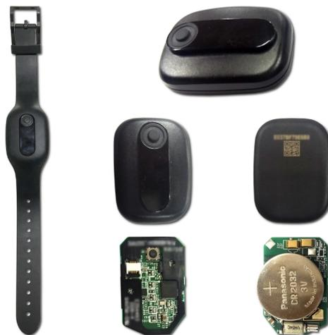
Figura 5.2: Dispositivos do tipo *smartwatch* baseados em Bluetooth que foram usados como dispositivos móveis.
