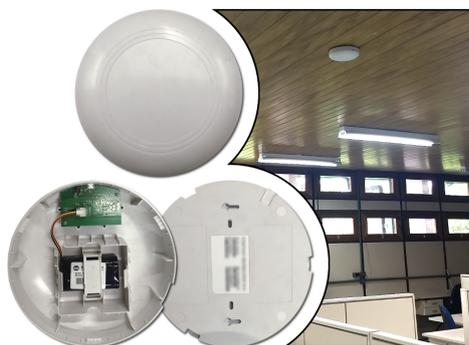
Figura 5.3: Os pontos de acesso baseados em Bluetooth que foram usados como nós âncora.
