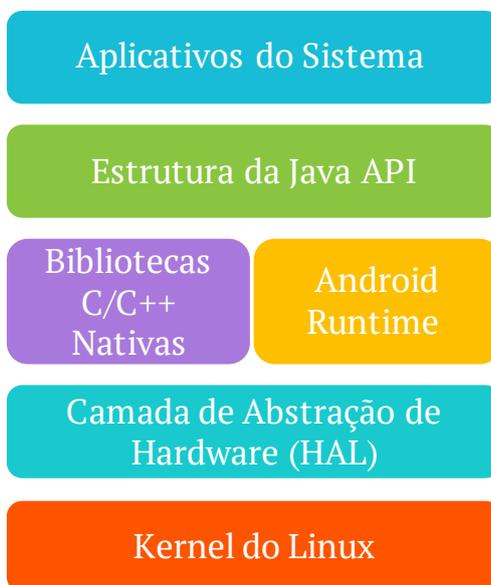
Figura 2.1: Visão geral da arquitetura do Android (adaptado de [Android \(2022b\)](#)).
