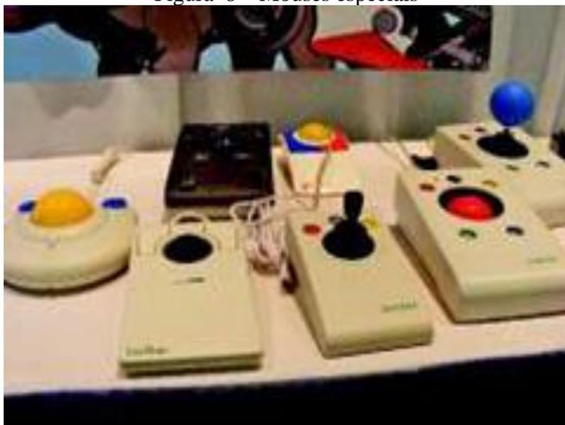
Sete mouses de diferentes formatos, em que o direcionamento do cursor é feito com joystick ou manuseando-se uma grande bola colocada sobre o mouse; os botões de ativação do clique e da tecla direita são dispostos no próprio mouse.
