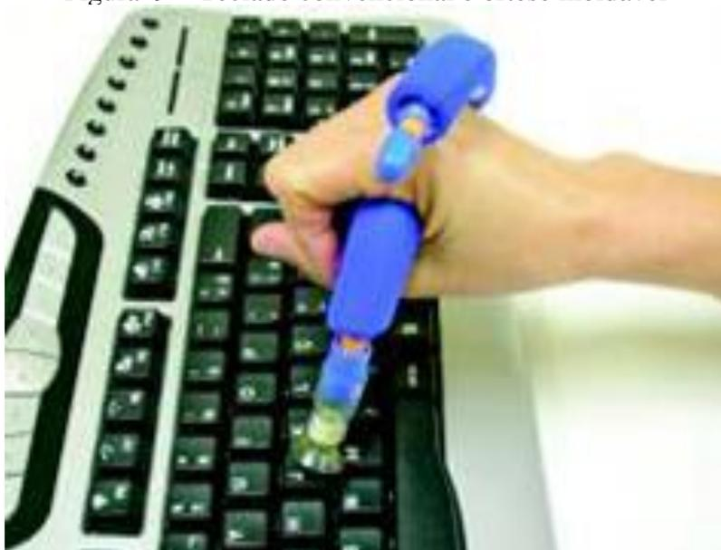
Estudante digita em teclado convencional utilizando uma órtese; essa órtese é moldável, ajustada e fixada à sua mão; na ponta da órtese, local que toca as teclas, existe uma ventosa de borracha que possibilita a aderência ao recurso à tecla.
