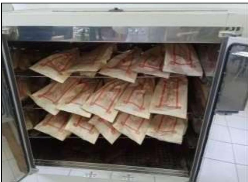
**Figura 19:** Secagem do material na estufa.
