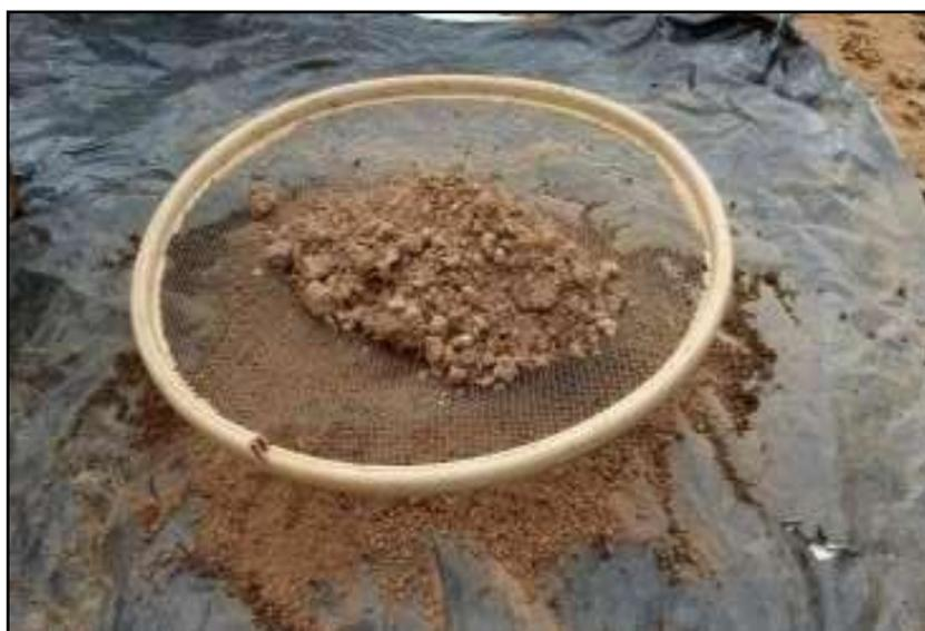
**Figura 2:** Processo de peneiramento dos materiais para retirar as partículas grosseiras.
