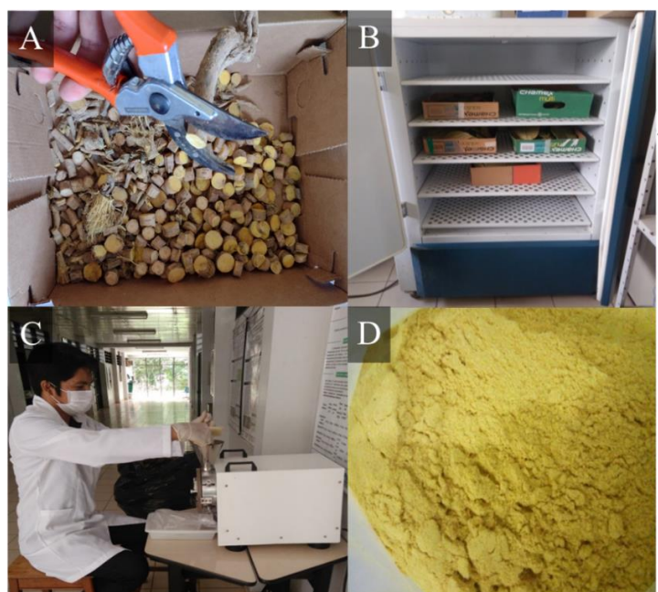
Figura 02. A) Separação das partes vegetativas (raízes de timbó); B) Secagem em estufa; C) trituração em moinho de facas; D) Pó vegetal (raízes de timbó).
