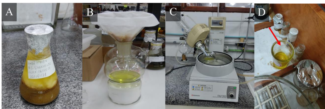
Figura 05. A) Maceração a frio; B) Filtragem do solvente orgânico; C) Rotaevaporação; D) Frasco com extrato orgânico em secador.
