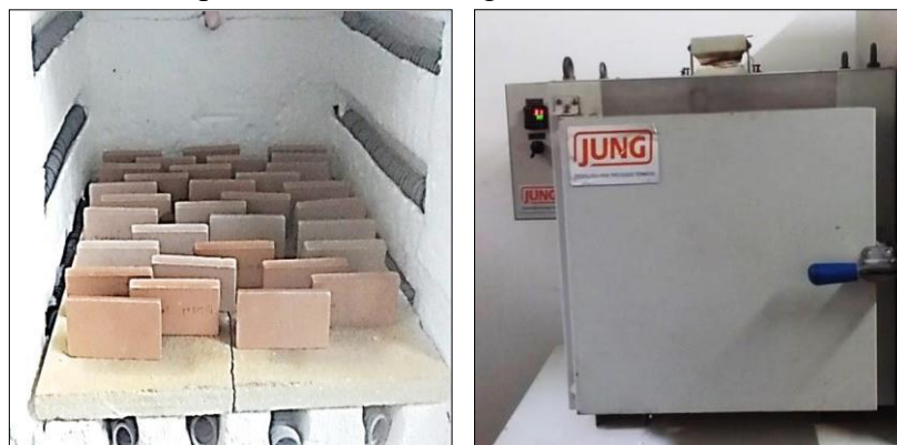
Figura 10 – Forno mufla da marca JUNG, (a) Organização das peças no interior do forno para realização de queima. (b): Ver-se o forno iniciando o processo de queima com gerenciamento e controle por meio de termopar. Fonte: própria 2022.
