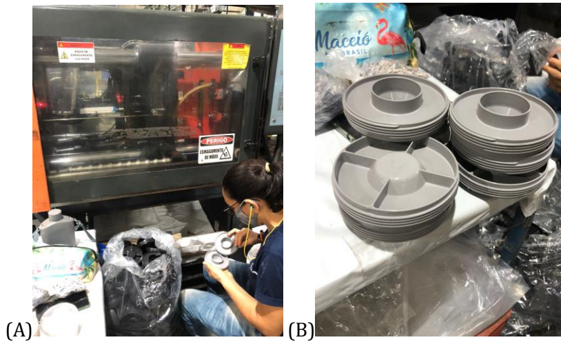
Figura 51: Saída da dupla de peças da injetora (A), peças injetadas com fibra (B).
