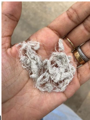
Figura 46: Amostra de fibra após 7 min. no aglutinador (A) e adição do PP ao aglutinador (B).
