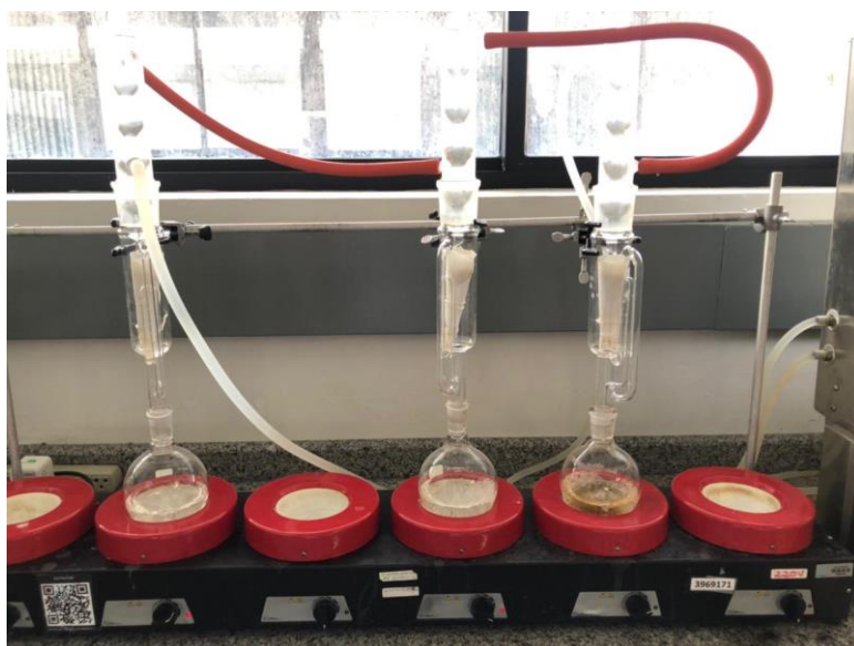
Figura 21: Sistema de extração por Soxhlet
