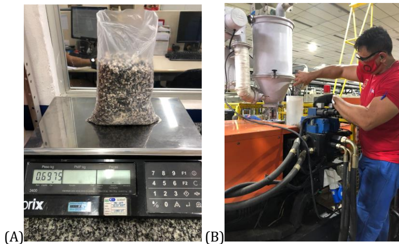
Figura 50: Pesagem dos pellets (A), operador alimentando a injetora (B).
