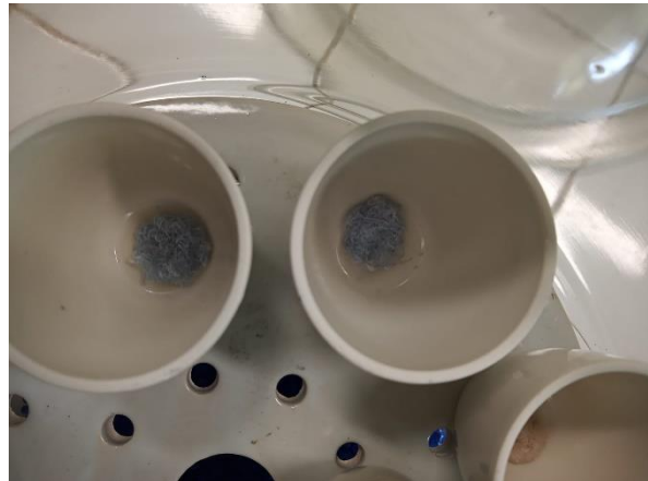
Figura 19: Amostras já calcinadas, resfriando a temperatura ambiente em dessecador.
