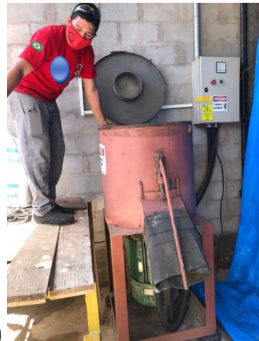
Figura 45: Fibra de curauá sendo pesada (A) e equipamento aglutinador utilizado para mistura (B).
