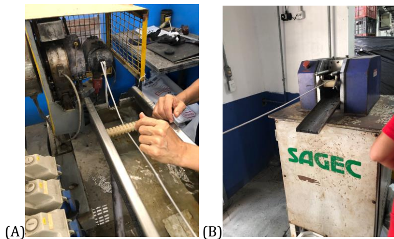
Figura 48: Filamento sendo resfriado e preparado para o corte (A) e equipamento responsável pelo corte (B).
