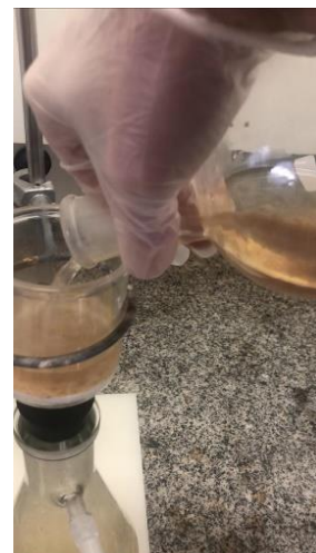
Figura 28: Transferência da solução contida no balão para o funil.
