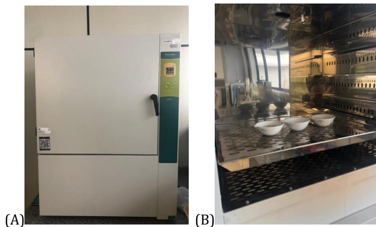
Figura 16: Estufa com circulação de ar (A) e estufa com circulação de ar com conjuntos cadinhos-fibras (B).
