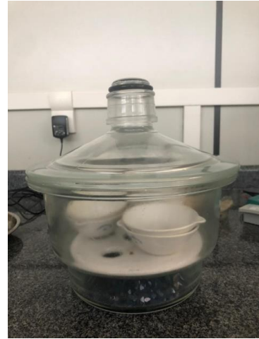
Figura 17: Cadinhos sendo resfriados em dessecador.
