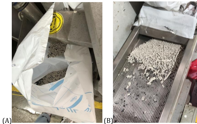
Figura 49: Pellets fora do padrão (A) e processo de peneiramento dos pellets (B).
