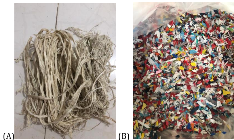
Figura 43: Fibra de curauá (A) e embalagens de PP pós-consumo trituradas (B).
