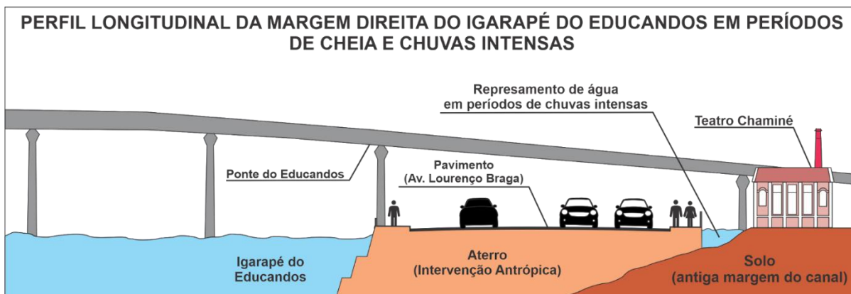
Figura 51: Perfil Longitudinal da margem direita do igarapé do Educandos em períodos de chuvas intensas e cheias.
