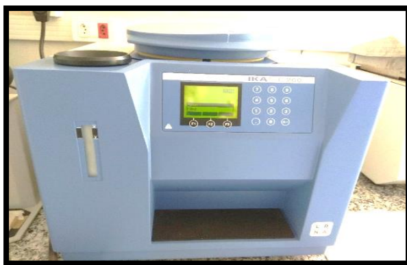
Figura 2 - Bomba calorimétrica Ika C200, laboratório da FZEA Pirassununga, SP.
