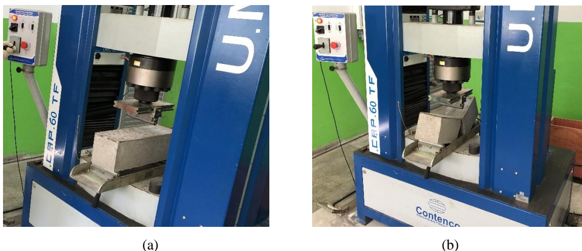
Figura 31: Ensaio de flexão: (a) demonstração do corpo de prova antes da aplicação da carga; (b) finalização do ensaio com ruptura da viga de ensaio.
