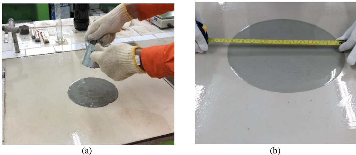
Figura 24: Ensaio de Kantho de compatibilidade do cimento e do superplastificante Tec Fluid 1000: (a) levantamento vertical do minicone; (b) medida do espalhamento após 2 minutos para a estabilização do material.
