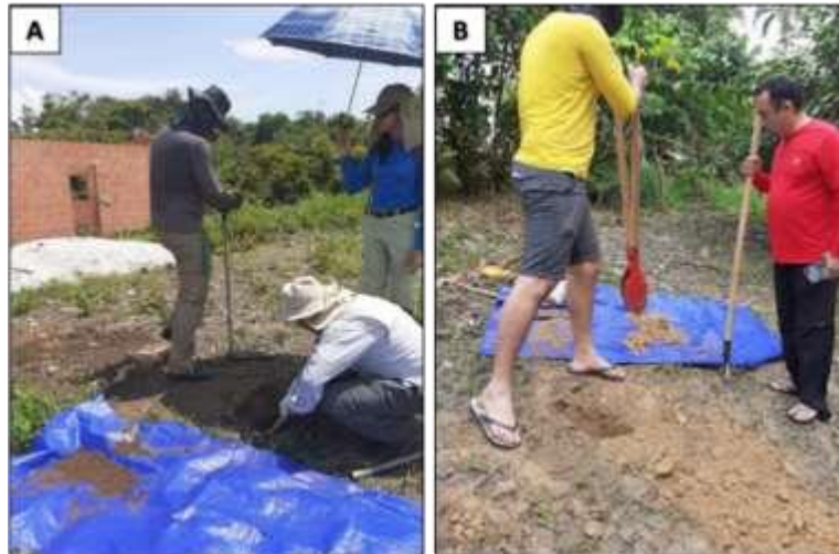
Figura 10: Material para coleta de amostras, A – Amostra coletadas com trado e B - Amostras coletadas com boca de lobo e ponteira.
