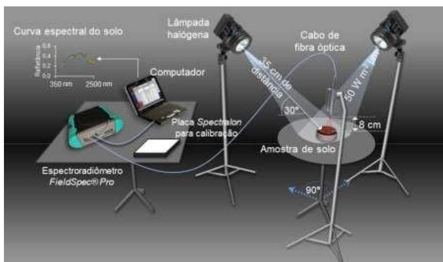
Figura 13: Esquema representativo da geometria de aquisição de dados, equipamento FieldSpec. Fonte: Poppiel, 2019.
