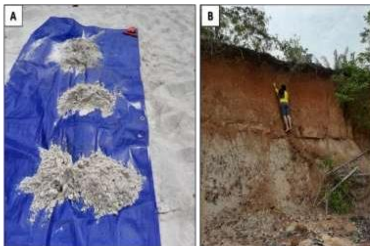
Figura 11: Amostragem na área de estudo, A - Coleta de amostras a cada 0,20 m e B - Coletade amostras em afloramentos em diferentes horizontes pedológicos.
