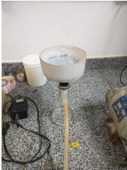
Figura 2 - Filtração a vácuo, das amostras de carvão com cloreto de zinco.
