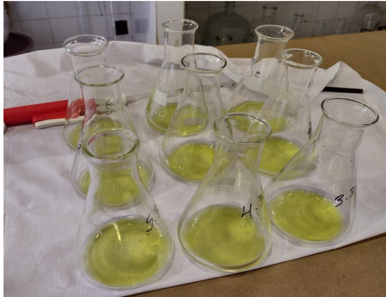
Figura 16. Solução para determinação do teor de cloreto pelo método de titulação (Autor, 2023).
