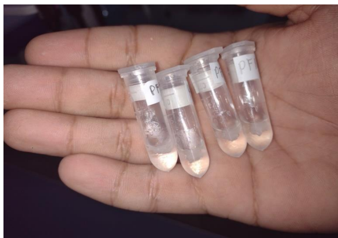
Figura 19. Tubos de eppendorf contendo a carne de pirarucu com 550 \mu L de solvente deuterado (D 2 O) para o processo de sonicação (Autor, 2022).
