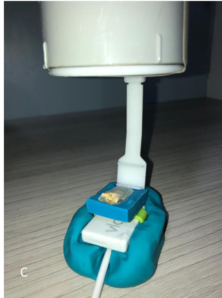
Figura 3.A –Plataforma de silicone para padronizar a posição dos espécimes durante tomografia computadorizada. 3.B – Plataforma posicionada no tomógrafo PaX-i3D. 3.C – padronização da posição do espécime para radiografia periapical com sensor digital.
