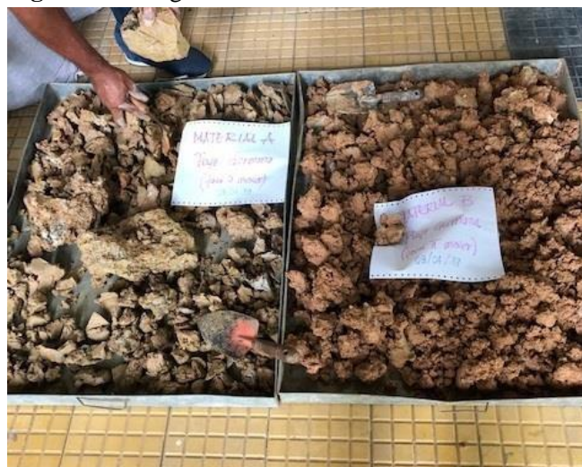
Figura 19 – Argilas coletadas em torrões secando ao ar
