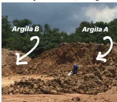
Figura 16 – Argila A (maior teor de plasticidade) e Argila B (maior teor de areia)
