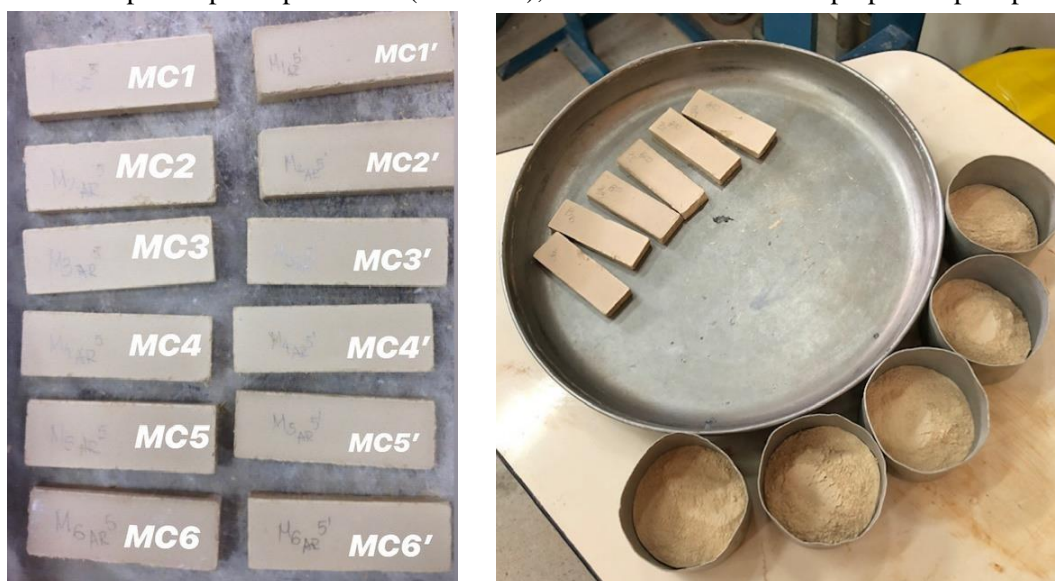
Figura 22 – Corpos de prova prensados (barrinhas), estado “verde” e massa preparada para prensagem
