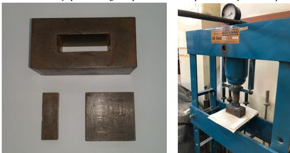
Figura 21 – Matriz de aço para moldagem e prensa hidráulica para fabricação dos corpos de prova
