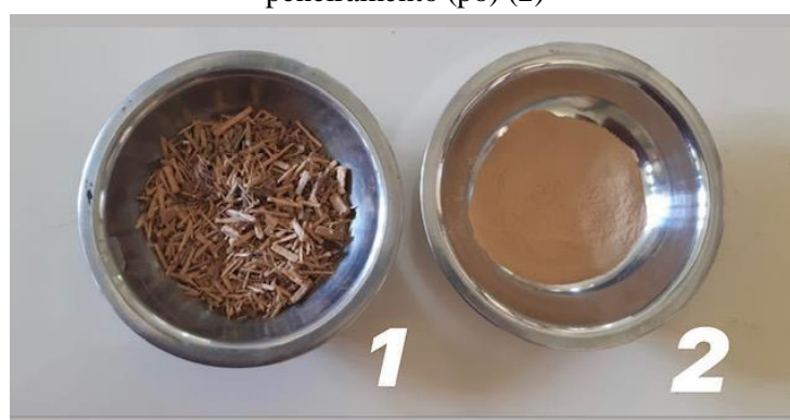
Figura 18 – Resíduo sólido em forma de serragem (1) e resíduo após o processo de moagem e peneiramento (pó) (2)
