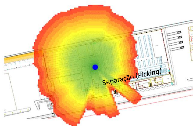
Figura 7 – Irradiação de sinal pelo ponto de acesso wireless
