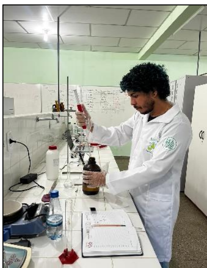
Figura 16: Titulação clássica para a padronização do titulante.
