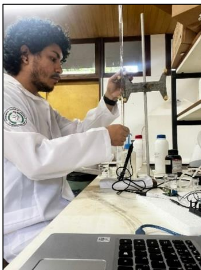
Figura 17: Realização da titulação potenciométrica para a validação do método automático.
