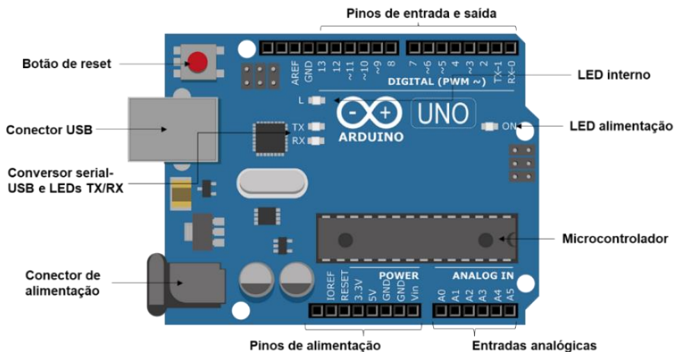
Figura 4: Placa do Arduino UNO e seus componentes detalhados. Fonte: Mota (2017).
