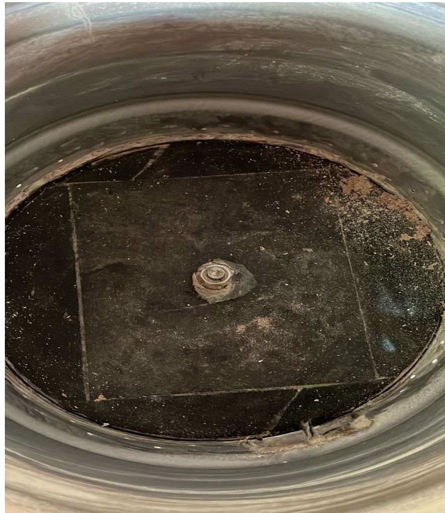
Imagem 21- Lixas adaptadas dentro do Tonel de alumínio transformada em centrífuga para lixar as sementes
