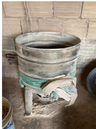
Imagem 19- Tonel de Alumínio adaptado como centrífuga para lixar as sementes
