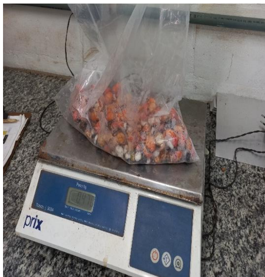
Figura 9. Balança digital utilizada para medição da massa de frutos (g) de guaraná. Embrapa Amazônia Ocidental, 2023.
