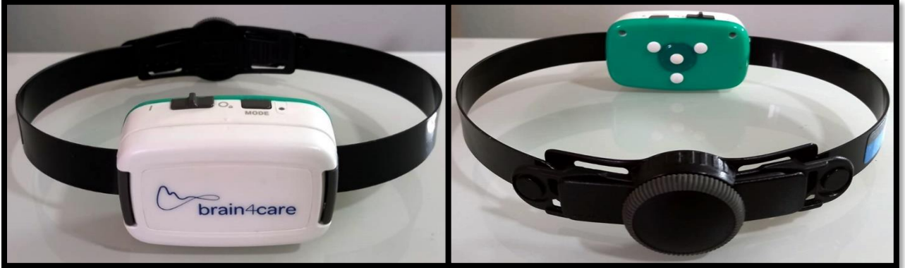
Figura 3 – Dispositivo não invasivo para análise da morfologia da onda de pulso da PIC. Fonte: Arquivo Pessoal.
