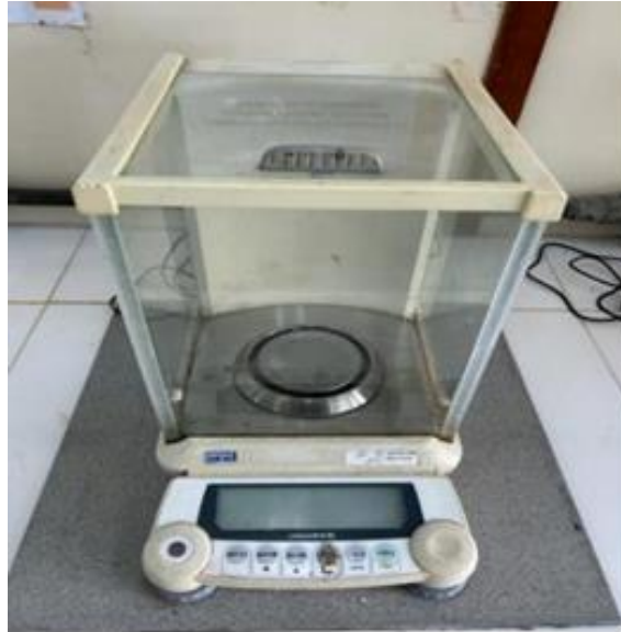
Figura 12 - Balança analítica da marca Shimadzu™
