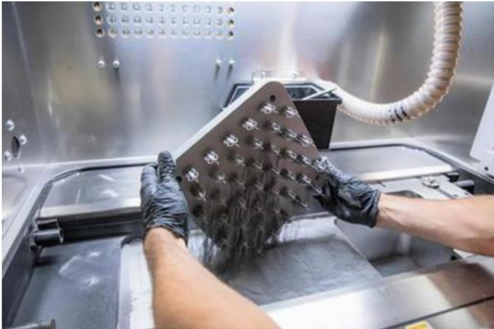
Figura 5 - Sinterização direta a laser de metal (DMLS)
