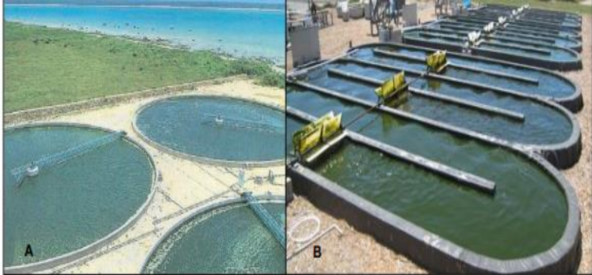
Figura 7: Sistemas abertos de cultivo de microalga a) lagoas abertas circulares e b) pista de corrida ( Raceway )
