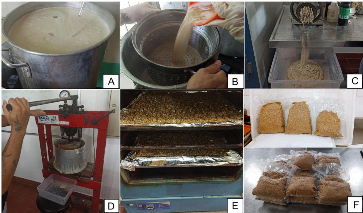
**Figura 2.** Etapas da produção de farinha de resíduos de tambaqui. (A) Cocção; (B) Descarte da água de cozimento; (C) Moagem; (D) Prensagem; (E) Secagem em estufa a 105°C; (F) Farinha embalada à vácuo.
